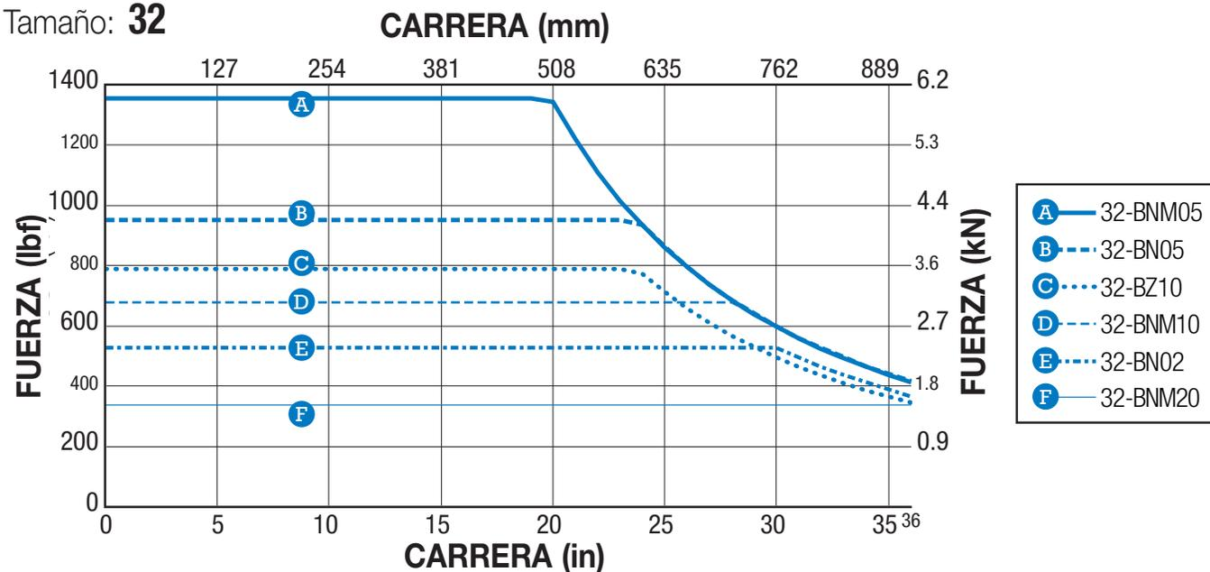
**NOTA:** Los límites de carga de pandeo indicados suponen una alineación perfecta. Se recomienda utilizar un margen de seguridad adicional, especialmente en aplicaciones de empuje elevado.
