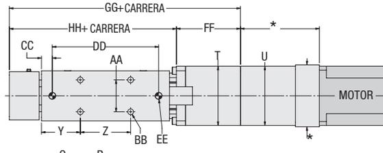
RP Montaje del motor
